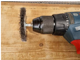
Mit Bohrmaschine und Drahtbürste Innenwände der Beuten aufrauen: je rauer, desto besser!
